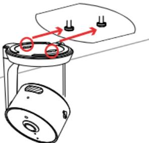
Aliniaţi orificiile de prindere din partea din spate a camerei cu cele două şuruburi. Glisaţi camera în jos pentru a o fixa la locul ei.
