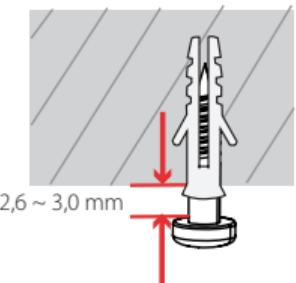
Înşurubaţi şuruburile în ancore, lăsând expusă în afară partea de sus a şuruburilor. Nu strângeţi prea tare şuruburile.
