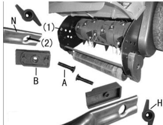
Insérez la vis de fixation (A) depuis l'intérieur à travers l'élément gauche. Positionnez l'élément d'isolation (B) depuis l'extérieur ; les deux petits morceaux doivent se bloquer dans les orifices de l'élément latéral (2). Installez l'élément d'isolation (B) de sorte que la grande ouverture pointe vers l'extérieur. Positionnez l'extrémité de l'élément de poignée (N) dans l'élément d'isolation (B). Serrez ensuite l'écrou à oreilles (H). Montez l'élément droit de poignée dans le même ordre.
