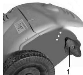
La profondeur de travail peut être réglée sur 3 hauteurs. Tirez le bras de réglage (1) pour l'éloigner du capot latéral et laissez-le s'accrocher dans la position souhaitée (2). Réglez alternativement la hauteur à gauche et à droite sur une seule position. Les bras de réglage doivent toujours être dans la même position en hauteur.
