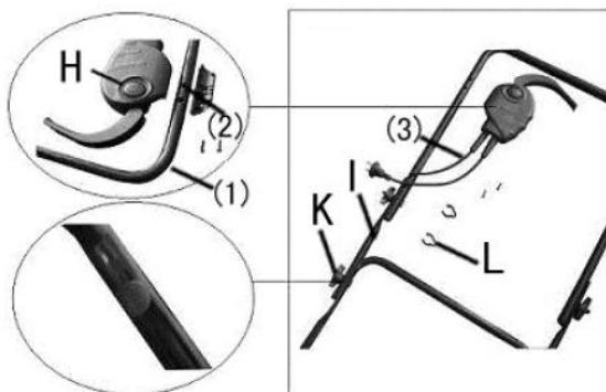
Serrez le câble du commutateur à l'aide des attaches (L) sur la tige de poignée.
