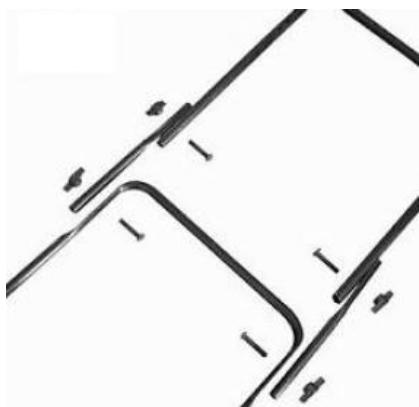
Oba díly přimontujte k sobě pomocí šroubů se speciálním tvarem hlavy (C) a upevněte šrouby v místě křídlovými maticemi (H).
