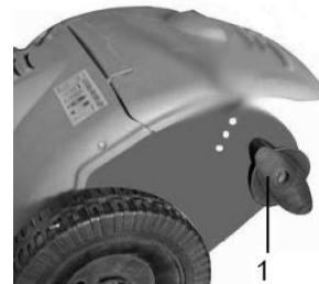
Pracovní hloubka je nastavitelná na 3 výšky. Vytáhněte seřizovací rameno (1) od bočního krytu a nastavte výšku do požadované polohy (2). Nastavujte výšku střídavě vlevo a vpravo pouze o 1 pozici. Ramena nastavení musí být vždy ve stejné výškové poloze.
