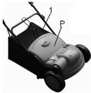
Til de beschermkap (P) op. Hang de opvangzak (1) met de haken aan beide bouten aan de zijkant van de beugel.
