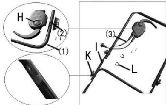
Zet de kabel van de schakelaar met de clips (L) vast op de beugel.
