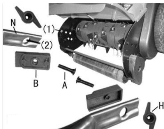
Vložte zajišťovací šroub (A) zevnitř do levého bočního elementu. Umístěte prvek (B) z vnější strany; dva výstupky musí zacpatnout do otvorů bočního prvku (2). Umístěte prvek (B) tak, aby velké vystouplé body směřovaly ven. Umístěte konec rukojeti (N) do prvku (B). Poté utáhněte křídlovou matici (H).
