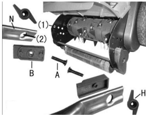
Steek de montageschroef (A) van binnenuit doorheen het linkse onderdeel. Breng onderdeel (B) langs de buitenkant aan; de twee nokken moeten in de gaten van het onderdeel aan de zijkant (2) passen. (Plaats onderdeel (B) zó dat de grote opening naar buiten wijst). Duw het uiteinde van de beugel (N) in het onderdeel (B).. Zet alles vast met de vleugelmoer (H). Monteer het gedeelte aan de rechterkant in dezelfde volgorde.
