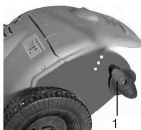
De werkhoogte is instelbaar in 3 standen. Trek aan de instelhendel (1) in de richting weg van de zijkant en laat hem in de gewenste stand (2) terugklikken. Stel de hoogte links en rechts om beurten met 1 standje bij. De instelhendels moeten altijd in dezelfde stand staan.
