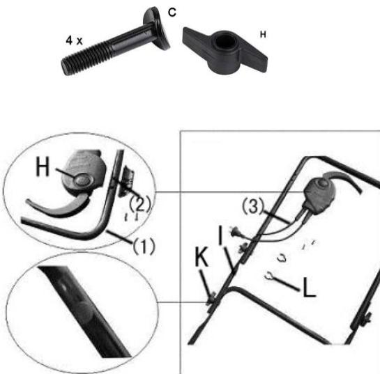
Připevněte spínače kabelu pomocí klipů (L) na rukojeti.
