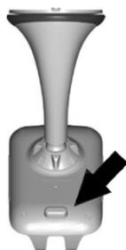
Naciśnij przycisk znajdujący się na tylnej części uchwytu, aby zwolnić urządzenie.
