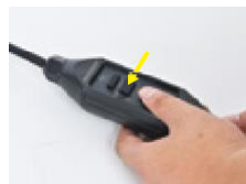
4. Stiskněte tlačítko «RESET», kontrolka se rozsvítí červeně. Proudový chránič funguje.
