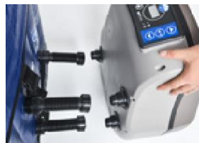
3) Z čerpadla odšroubujte tři konektory.
