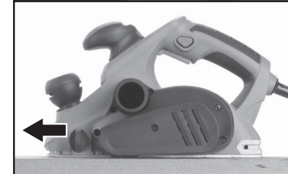
Obr. 5B, sklopení trnu při hoblování od kraje
