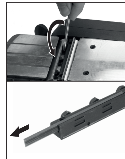
Obr. 8, uložení a vyjmutí hoblovacích nožů u hoblíku EP 850
