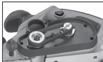
Obr. 11, hnací remeň na modele hobľníka EP 850
