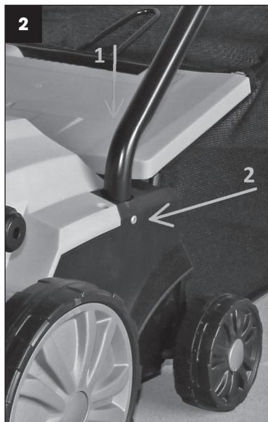
**⚠ FIGYELEM!** A fogantyú aljának a felső részén lévő mélyedéseknek befelé kell állniuk. (3. ábra).
