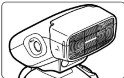
A kulcsszám 22 (ISO 100 esetén, méterben). A vaku maximális hatótávolsága megfelel az EF 28 mm-es nagy látószögű objektívnek (EF-S 18 mm).
