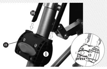
Для того, чтобы снять детское кресло, нажмите кнопку блокировки (I3) и вытащите его в указанном направлении.
