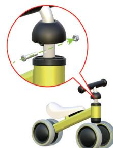
Zajistěte řidítka 3 a tyč předního soukolí 2 šroubem a maticí 3 pomocí montážního klíče 4, potom upevněte horní kryt.
