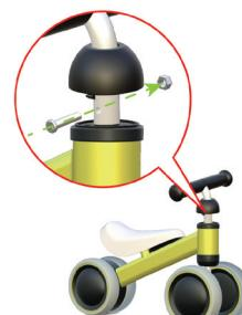
Zaistite riadiidlá 3 a tyč predného súkolesia 2 skrutkou a maticou 3 pomocou montážneho kľúča 4, potom upevnite horný kryt.
