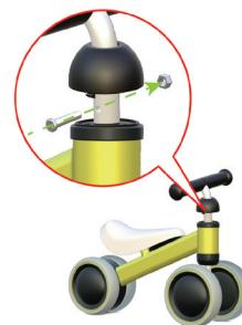
Fissare il manubrio 3 e la barra della coppia di ruote anteriori con la vite e il dado 3 aiutandosi con la chiave di montaggio 4, quindi fissare il coperchio superiore.
