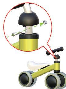
Zabezpiecz kierownicę 3 oraz drążek podwójnych kółek przednich 2 śrubą i nakrętką 3 za pomocą klucza montażowego 4, potem zamocuj osłonę górną.
