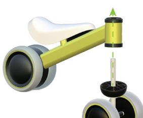
Włóż podwójne kółka przednie do otworu w ramie rowerka biegowego 1.
