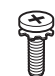
Vijci za postolje 5 EA, M4 x L14 (Samo 55EF95**) 8 EA, M4 x L14 (Samo 65EF95**) (Pogledajte str. A-7, A-9)
