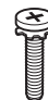
Statņa skrūves 4 EA, M4 x L20 (Tikai modelim 55EG91**) 5 EA, M4 x L20 (Tikai modelim 55EG92**, 55EG96**) 8 EA, M4 x L20 (Tikai modelim 65EG96**) (Sk. A-3, A-4, A-6)
